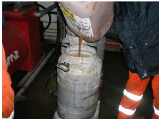
Dyzelino ir BVL Biosurfactant maišymas
