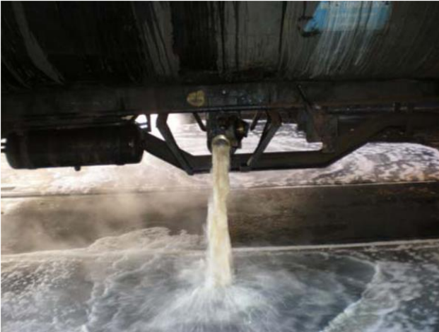
Cisternos išleidimas po plovimo
