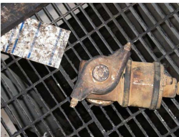
Didelio slėgio rotacinė plovimo galvutė
